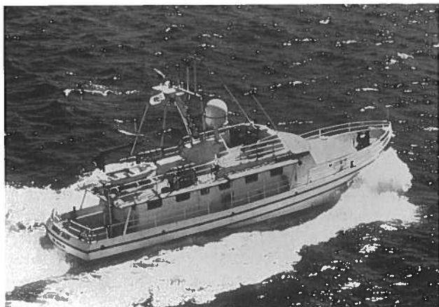
◀ Foto 4 De Inmarsat-A antenne is ondergebracht in een koepelvormige witte behuizing ('dome') en bevindt zich op de foto direct naast de mast.
