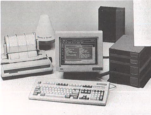
▲ Foto 4 Inmarsat-C configuratie met op de achtergrond de kegelvormige Inmarsat-C antenne
